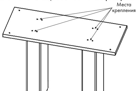
**4** С основания снять защитную белую пленку. Крепить основание к колоннам с помощью Болтов М8х50 (8 шт) и Шайб М8 (8 шт)
