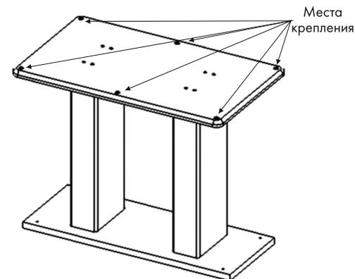
**6** Крепить полученную конструкцию к столешнице с помощью Болтов М8х40 (4 шт), Шайб М8 (4 шт) и Гайки М8 (4 шт).
