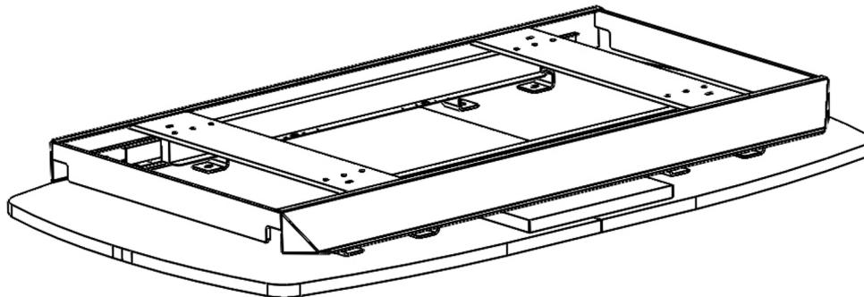
**3** Прикрутить колонный к столешнице с помощью болтов, гаек и шайб.
